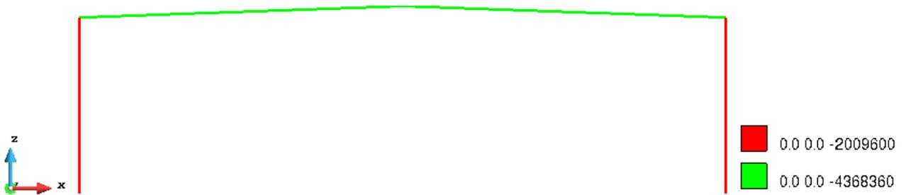
Figure 13-5 : Charges réparties appliquées sur le portique de la cellule 2 (en mN/m)
