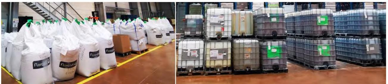
Figure 3-4 : Stockage de matières premières solides dans des big bags (à gauche), liquides dans des GRV (à droite)
