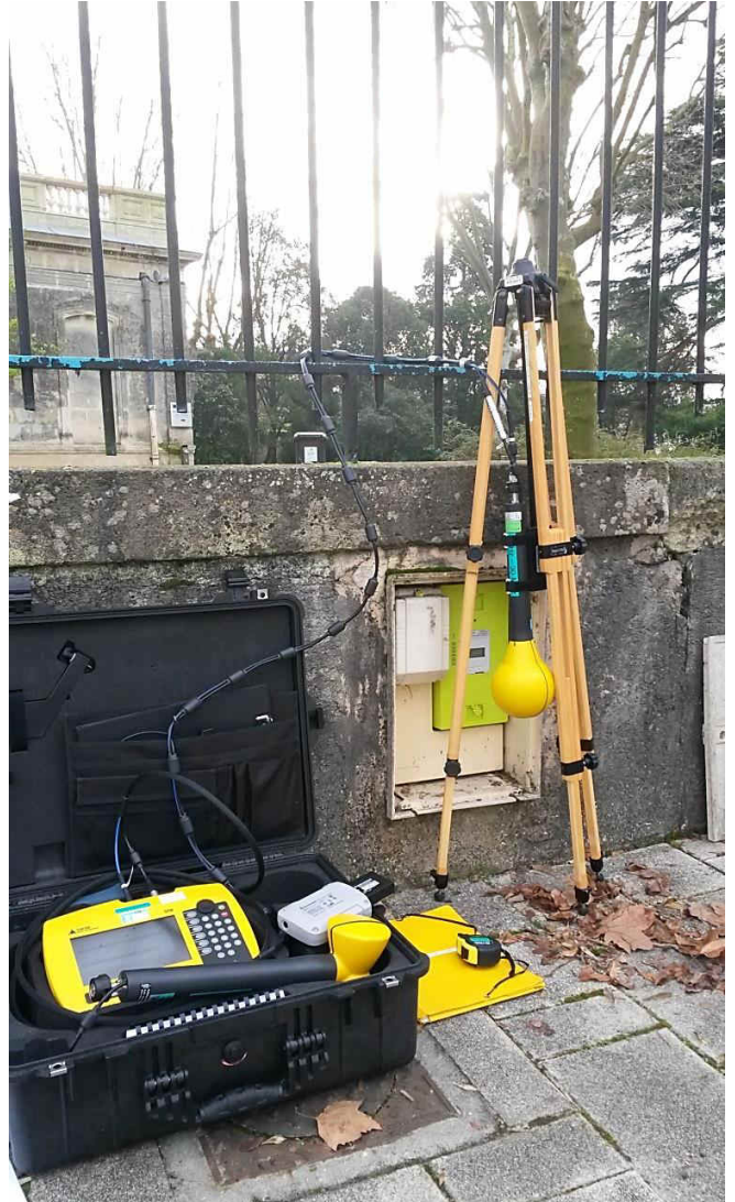
Mesure avec l'antenne électrique puis magnétique devant le compteur ; derrière la grille on aperçoit l'école de musique
